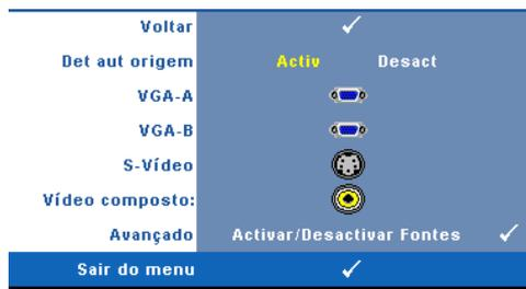
**DET AUT ORIGEM**—Selecione a opção **Desligado** (predefinição) para bloquear o sinal de entrada actual. Se premir o botão **Fonte** quando o modo **Deteção Automática de Fonte** estiver definido para **Desligado**, é possível seleccionar o sinal de entrada manualmente.
