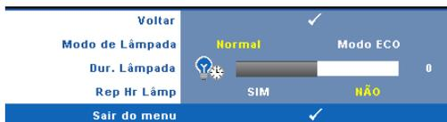
**MODO DE LÂMPADA**—Permite seleccionar entre os modos Normal e Eco.
